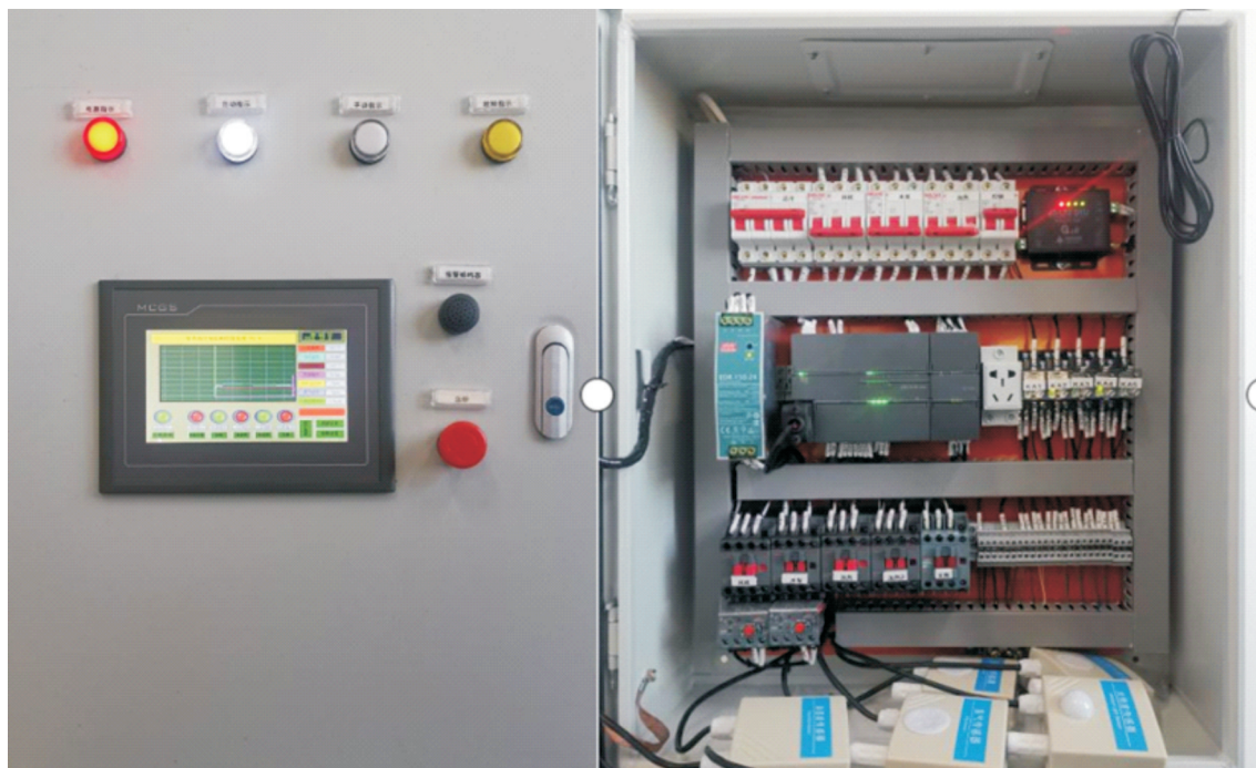
图 2 控制系统样机
